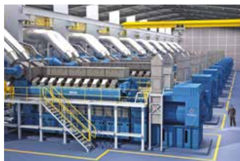
„The Power of 10“ – eine modulare Microgrid-Energielösung mit 10-MW-Bergen-Motoren, Marelli-Generatoren und Stabilisierungstechnologie von Piller ermöglicht die schnelle Bereitstellung von Energie in großem Maßstab.“
